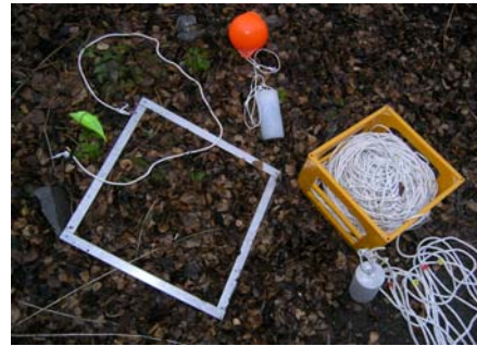
Inventeringskit med lina i förvaringsback, provruta och boj med tyngd.
